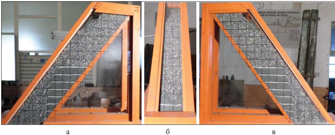
Рис. 6. Фізична модель після випуску чистої руди при відпрацюванні цілика, що огорожує очисну панель: а – вид з боку по пересіканню випускних отворів; б – вид з боку висячого боку; в – вид з боку по межі панелі
